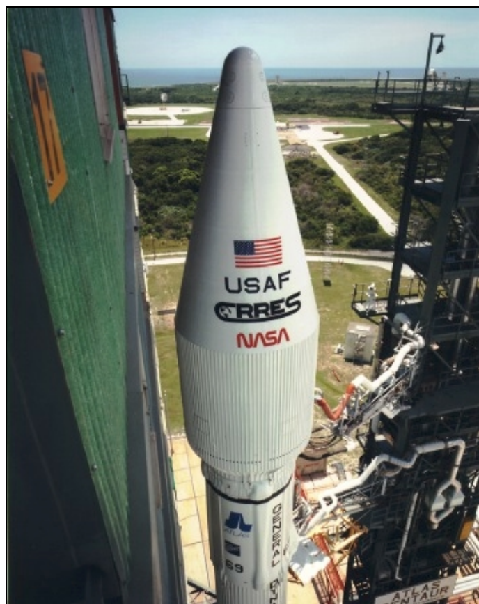
Aerodynamický kryt LPF (#AC-69, satelit CRRES).
