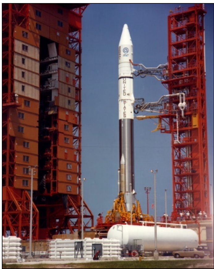
Příprava rakety Atlas SLV-3D Centaur D-1AR #AC-41 na startovací rampě 36B na Cape Canaveralu. 29. června 1978 raketa vynesla na oběžnou dráhu tři satelity Comstar.
