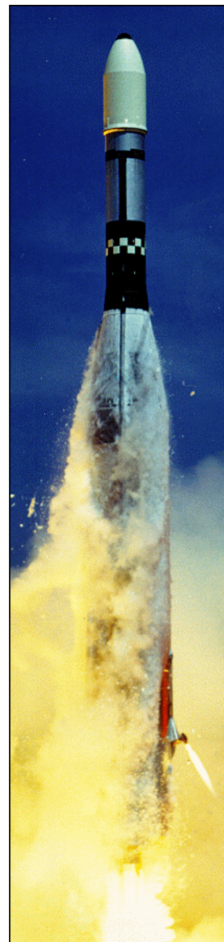
Start sond Mariner 3 (5. listopadu 1964, Atlas LV-3A Agena D) a Lunar Orbiter 1 (10. srpna 1966, Atlas SLV-3 Agena D). První sonda byla navedena na nesprávnou dráhu, protože nedošlo k oddělení aerodynamického krytu.
