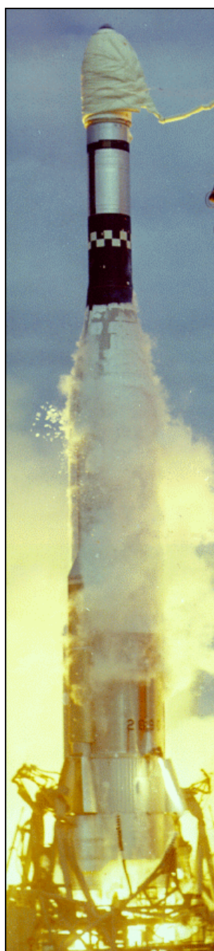
Start sond Mariner 3 (5. listopadu 1964, Atlas LV-3A Agena D) a Lunar Orbiter 1 (10. srpna 1966, Atlas SLV-3 Agena D). První sonda byla navedena na nesprávnou dráhu, protože nedošlo k oddělení aerodynamického krytu.
