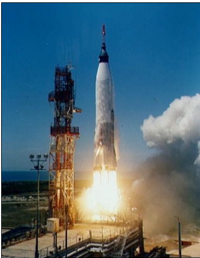
Neúspěšný start prvního plánovaného orbitálního letu (MA-3) na oběžnou dráhu 25. dubna 1962. Raketa byla 40 s po startu dálkově zničena pro závadu na řídicím systému.
