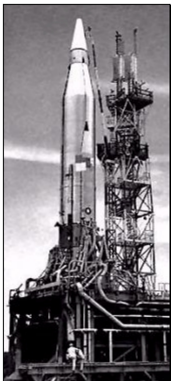
Raketa Atlas C #8C s experimentální odtavovací hlavicí RVX-2.
